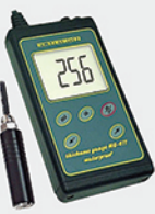
Coating Thickness Gauge جهاز محمول لقياس سمك طبقة الدهان على الأسطح الحديدية
